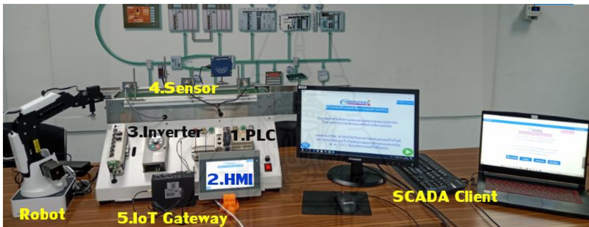
ภาพที่ 5 แสดงผลการวิจัยการพัฒนาชุดจำลองระบบสกาตาของอุปกรณ์ในสายพานการผลิต แขนกลและเครื่องลูกข่ายสกาตา
