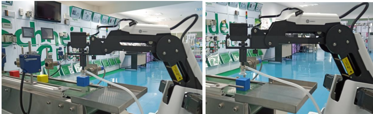
ภาพที่ 12 แสดงผลการวิจัยของการดัดจับชิ้นงานของแขนกลเพื่อปล่อยลงบนสายพานและนับจำนวนครั้งการทำงาน
